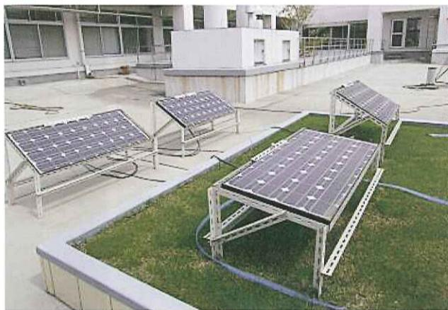
屋上に太陽光発電パネルを植物と併用して設置すると、床面温度上昇が抑えられ発熱効率が良くなることを実証する実験。パネルの下でも芝は生育可能であり、今後はその他の地被類でも実験予定。芝の上の二枚のパネルは、屋上全体での発電量を比較する実験。地面と平行にパネルを設置すると、パネル面積(枚数)を確保できる。(前)
